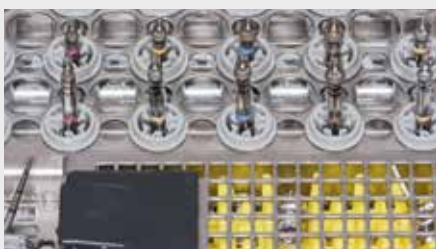
Abb. 7 Ergebnis der Vorreinigung im Ultraschallbad ohne manuelle Vorreinigung
