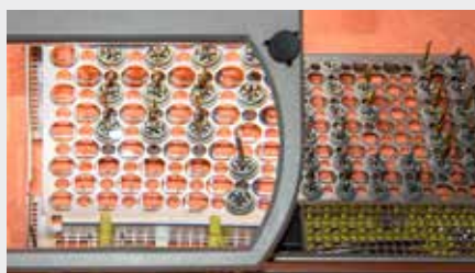
Abb. 8 Visuelle Kontrolle des Washtrays unter Lupenvergrößerung
